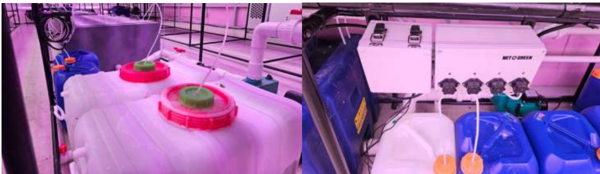
사진 | 재배 베드에 양액을 공급하는 양액탱크와 육묘 베드에 양액을 공급하는 양액탱크. 재배시기와 육묘시기의 최적화된 EC, pH 가 다르기 때문에 양액 탱크 및 양액 조절 시스템을 구분해서 운영.
